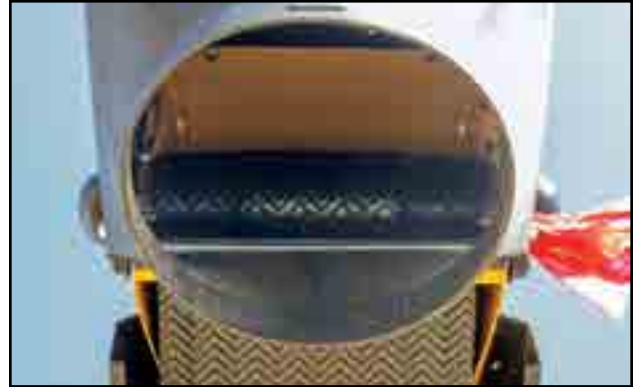
Fig. 94 - Intérieur du bec de déversement
