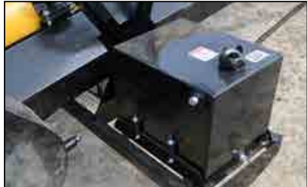
Fig. 66 - Réservoir de carburant
