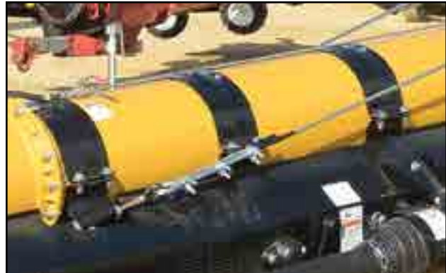
Fig. 82 - Boulons à œil et pontage de câbles
