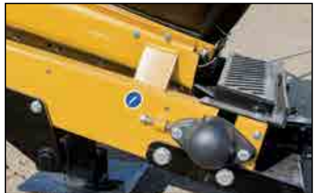
Fig. 85 - Boulon de réglage du rouleau de queue
