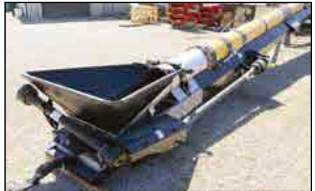
Fig. 64 - Extrémité de l'arbre longitudinal de la prise de force
