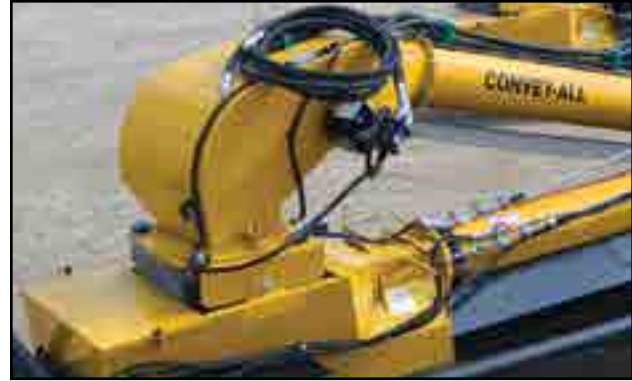
Fig. 38 - Décharge pivotante vers la trémie du convoyeur principal
