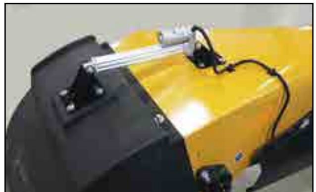
Fig. 27 - Bec de déversement avec actionneur électrique
