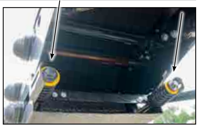
Fig. 69 - Boulons de tension, boîte d'entraînement de la tension du ressort
