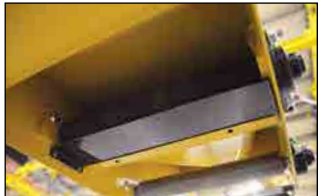
Fig. 100 - Plaque de confinement en place
