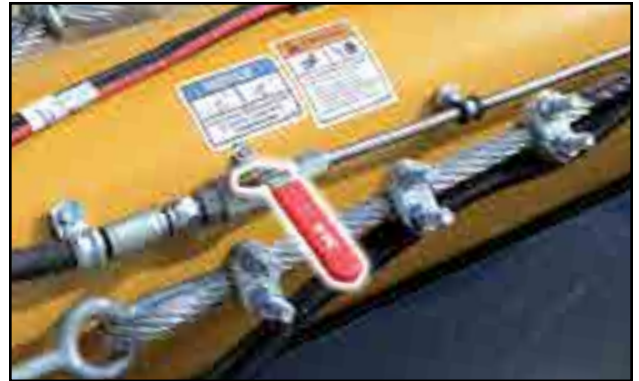
Fig. 18 - Valve hydraulique vers les cylindres du tube du convoyeur
