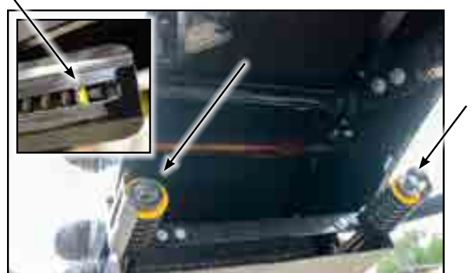
Fig. 86 - Boulons de tension de la boîte d'entraînement à ressort de tension avec indicateur de tension
